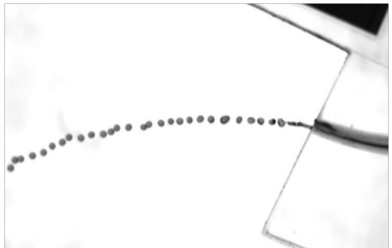
Abb. 2. Monodisperse Tropfen aus einer Gerinneströmung mit Gasbegleitstrom
